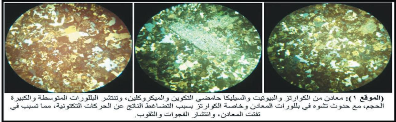
شكل (٤): التركيب المعدني للصخور النارية والمتحولة جنوب سيناء باستخدام الميكروسكوب المستقطب
